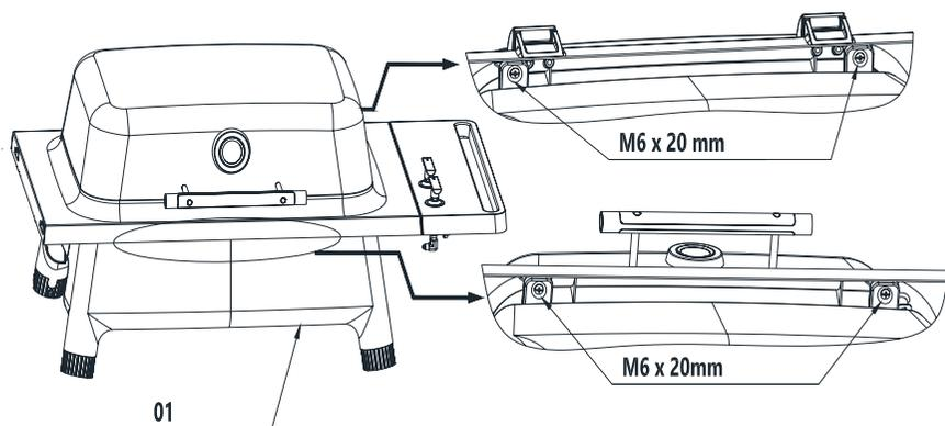
For at adskille grill/låg fra stativet sættes det let på skrå, så bagsiden er løftet, hvorefter begge M6x20mm-skruer fjernes. Gør så det samme med de to skrue foran. Hold grillen stabil under processen, så den ikke vælter. Gem alle skrue og spændeskiver til senere brug. Aftagelige klistermærker indikerer, hvor skrueerne senere skal fastgøres. Løft nu grillen med låget af stativoverdelen, og stil den på jorden.
