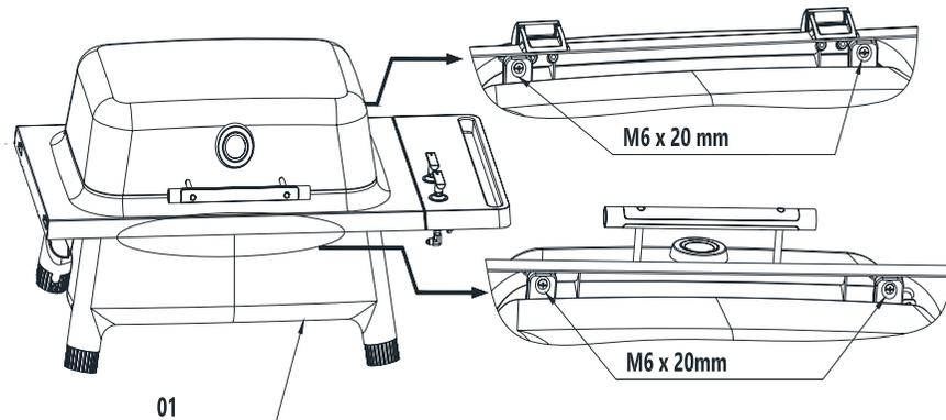
Kallista yhdistelmää hiukan taaksepäin ja irrota molemmat M6x20 mm pultit, toista sitten tämä etuosalle, tue osia niin että ne eivät pääse putoamaan. Säilytä kaikki kiinnitystarvikkeet myöhempää käyttöä varten. Tarrat osoittavat, minne pultit myöhemmin kiinnitetään. Nosta nyt grilli kansineen jalustalta ja laita osat sivuun.
