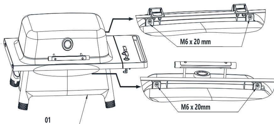
Kantel de montage licht naar achter en verwijder beide M6x20mm schroeven, doe dan hetzelfde aan de voorkant, de onderdelen ondersteunend zodat ze niet vallen. Bewaar alle bevestigingsmiddelen voor later gebruik. Verwijderbare stickers aan de voor- en achterkant markeren de posities van deze schroeven. Verwijder de kap en barbecueonderstel montage van de bovenkant van de standaard en plaats op de grond.
