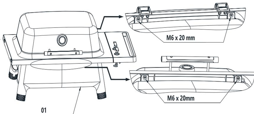
Vinkla anordningen en aning bakåt och ta bort båda M6x20mm skruvarna och gör sedan samma sak på framsidan, stötta delarna så de inte ramlar. Förvara alla fästena för senare användning. Avtagbara klistermärken på framsidan och baksidan markerar positioner för dessa skruvar.
